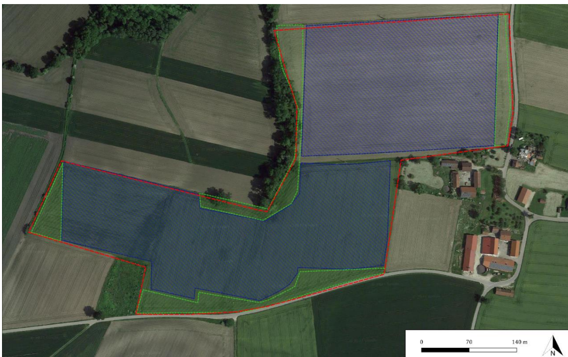
Abbildung 1 Übersicht über das Vorhaben. Plan der PV-Module (blaue Fläche) und der Begrünung (grüne Flächen) sowie das Untersuchungsgebiet (rot gestrichelt)
